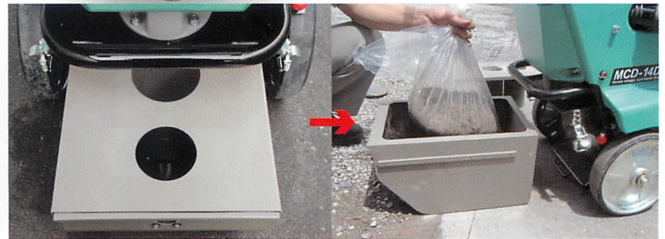
⑤ スライド式ダストケース (容量20ℓ) ※市販家庭用ビニール袋 (45ℓ) 使用
