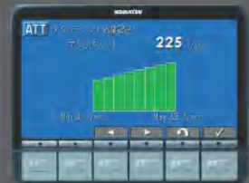
クラッシャ等アタッチメント(アタッチメントモード時)
