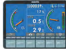
実荷重・定格荷重・負荷率表示
