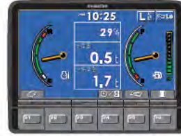
実荷重・定格荷重・負荷率表示
